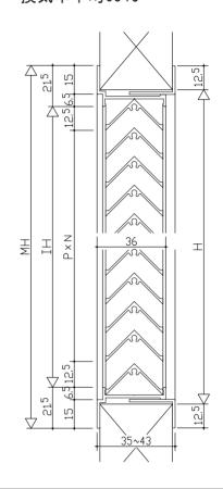
■30K型 片流れ羽根型ドアー厚調整式ガラリ
