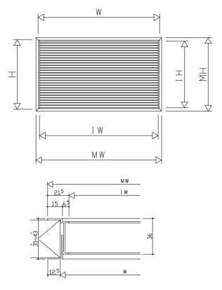
※適応ドアー厚35mm~43mm (min33mm~max53mm)
